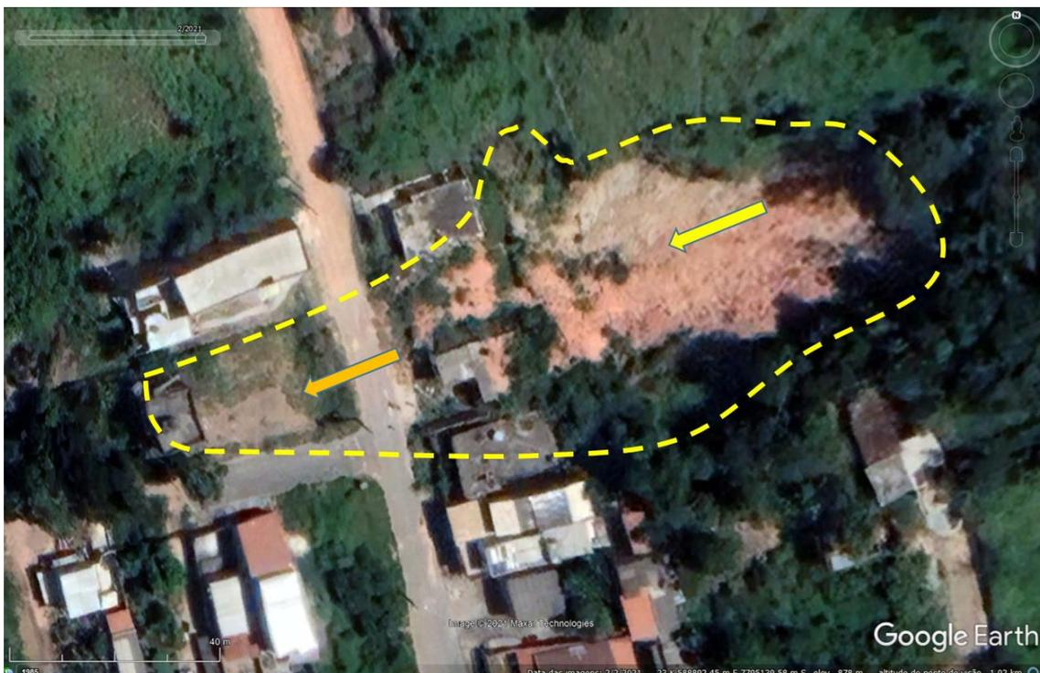
Figura 21 - Deslizamento translacional raso na Rua de Londres com representação esquemática da área de ocorrência, da direção do movimento. A seta amarela indica o provável comportamento translacional e seta laranja indica o provável comportamento como fluxo.
