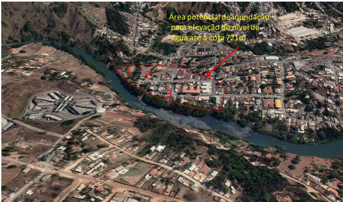
Figura 8 - Área potencial para inundação quando da elevação progressiva do nível de água até a altitude 721m.
