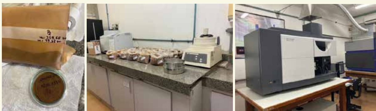
Figura 1: Amostra já peneirada com detalhe ao centro do processo de peneiramento e à direita o equipamento ICP-OES onde foram realizadas as análises químicas
