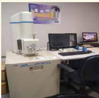
Figura 4: Equipamento MEV-EDS utilizado para a realização das análises mineralógicas
