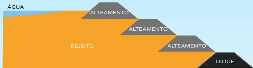
Em barragens a montante, é construído um dique inicial (base da construção) para comportar as primeiras camadas de deposição de rejeitos. Essas camadas são chamadas de alteamento. Estes alteamentos são construídos em cima do próprio rejeito, formando “degraus” na barragem ficando cada vez mais alta.
