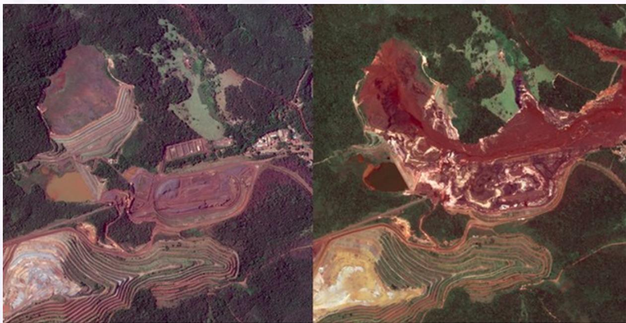
Área da Barragem da Mina Córrego do Feijão antes e depois da ruptura. (Fonte CRPM, 2019.)
